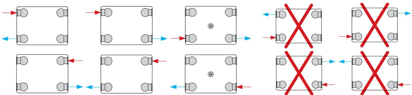
\* = Perte de puissance lors de chauffage à basse température en combinaison avec une grande différence de température entre entrée et retour.
